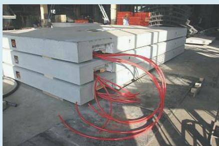
Готовые заводские фундаментные плиты с установленным теплым полом.
